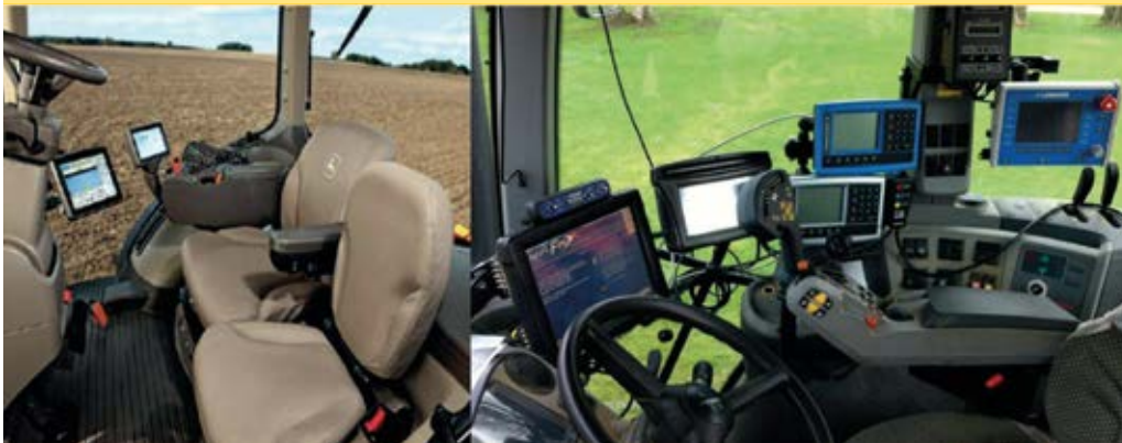
Figura 7. En lugar de tener diez cajas de control en la cabina, ISOBUS permite al operador emplear una pantalla para todo un grupo de aperos
