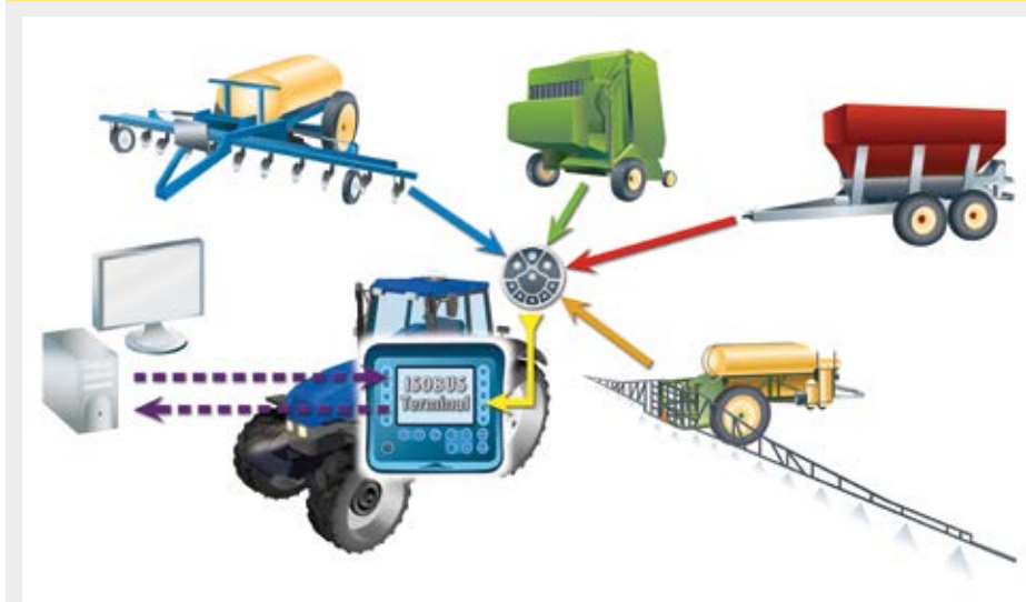
Figura 8. Esquema conceptual de conexiones usando ISOBUS
