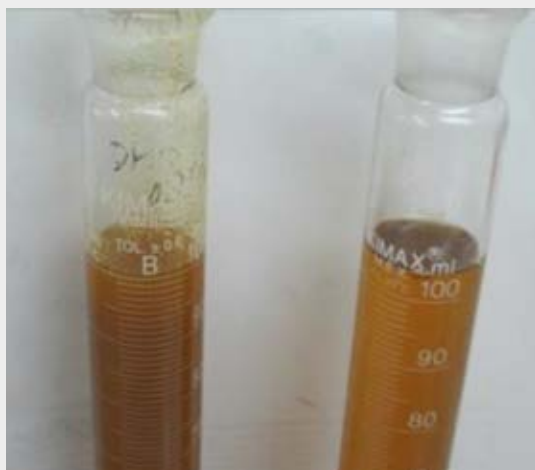
Figura 1. Imagen comparativa de aceite de pollo que llega a la empresa (izquierda) y el aceite obtenido de éste después del proceso de refinamiento en las instalaciones de UST (derecha)
